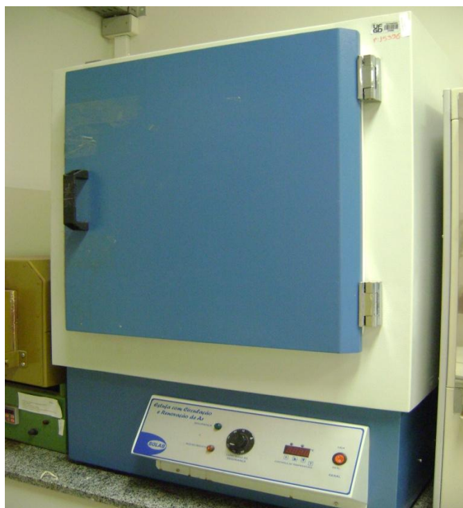
Figura 8: Estufa de secagem esterilização com circulação de ar da marca SOLAB, do LABPAM, utilizada no processo de degradação térmica das amostras em diferentes temperaturas.
